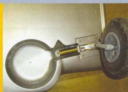
Das Fahrwerk stammt aus dem Hause WaBo und kann direkt bei Petrausch mitbestellt werden. Es findet seinen Platz im festen Mittelteil der Tragfläche.
